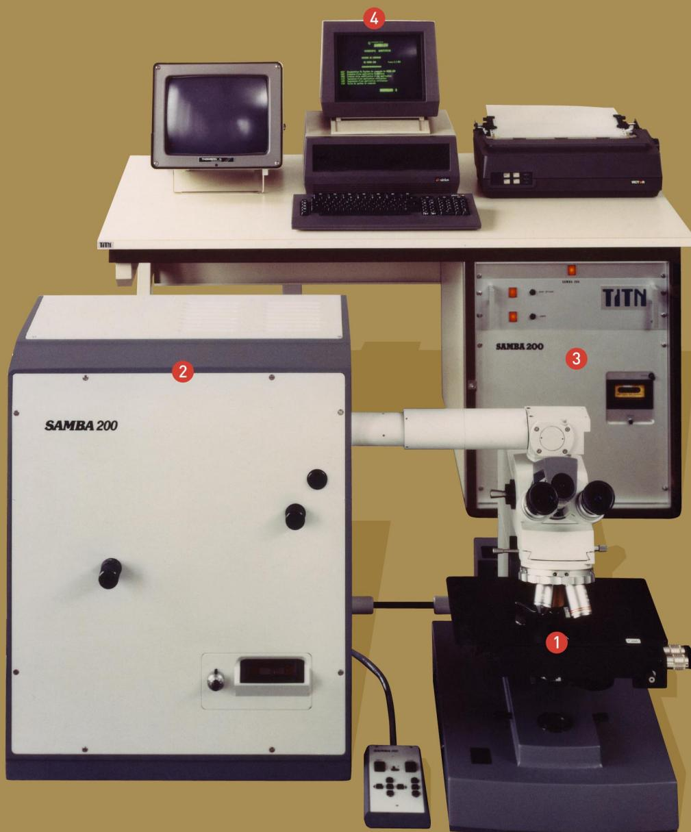
Le prototype comprend un microscope électronique avec platine motorisée 1, un bloc électronique de commande de la platine 2, un mini-calculateur 3, une console 4 et un terminal graphique 5. Le Samba 200 regroupe un microscope avec platine motorisée et autofocus 1, un capteur-analyseur d'images de basse et haute résolution 2, un bloc électronique de commande et de contrôle du capteur 3 et une interface utilisateur ou unité de commande 4.
