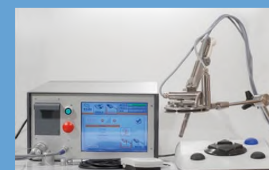
Le Viky, robot LER (ou Light Puncture Robot). Crédit ??? Appareil capable de porter et déplacer automatiquement une caméra endoscope dans le cadre de la chirurgie laparoscopique.
